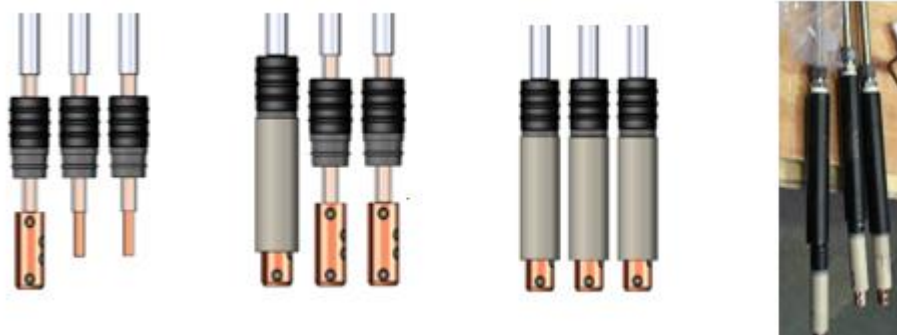
Slika 4-19. Montaža unutrašnjosti metalnog kućišta (INA d.d., 2019)
