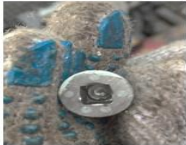
Slika 4-5. Prikaz čepa za protiskivanje ulja s insertima od različitih legura (INA d.d., 2019)
