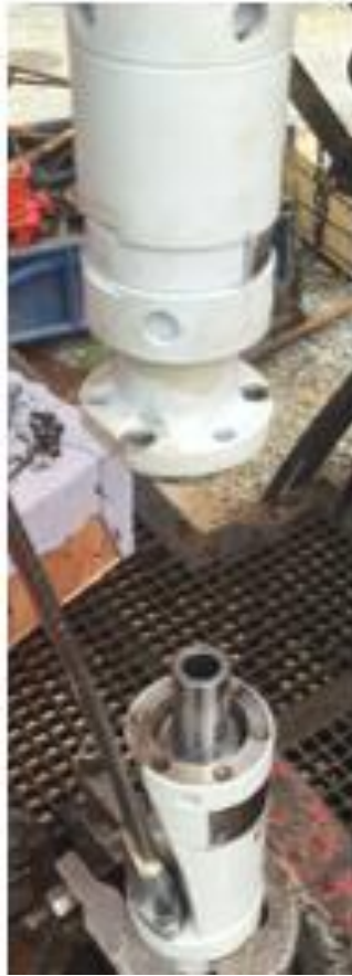
Slika 4-10. Zadizanje protektora i zamjena brtvi (INA d.d., 2019)
