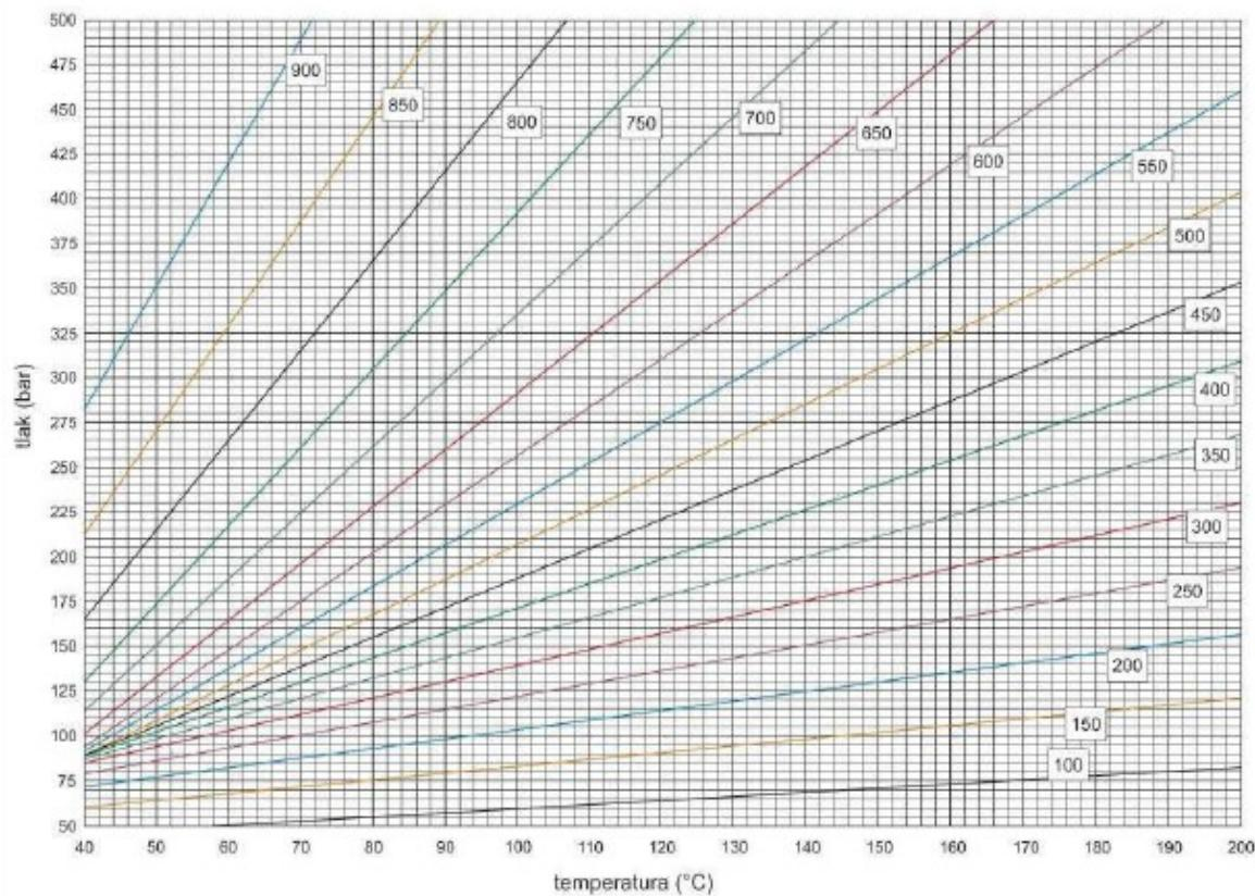
Slika 4-2. Ovisnost gustoće CO<sub>2</sub> (kg/m<sup>3</sup>) o tlaku (bar) i temperaturi (°C) (preuzeto iz Kolenković & Saftić, 2014; Vulin, 2010, prema Span & Wagner, 1996)
