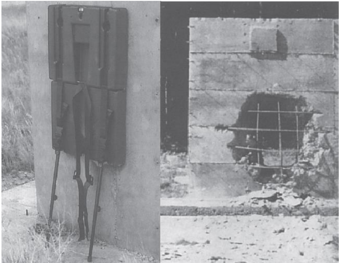
Slika 6-24 Primjer uređaja za razbijanje zidova "Breachcase" za vojne primjene (slika lijevo) i rezultati njegovog djelovanja (slika desno) (Weickert, 1998)
