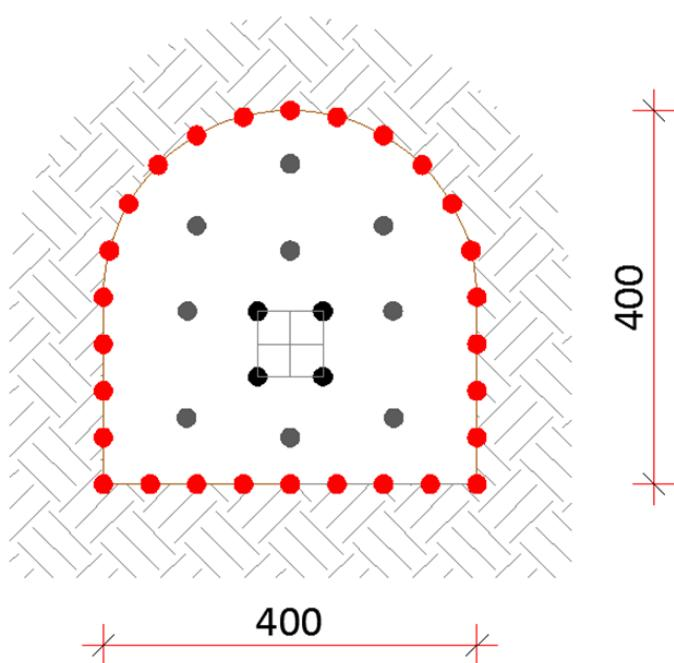
**Slika 8-1.** Raspored minskih bušotina za iskop dovoda
