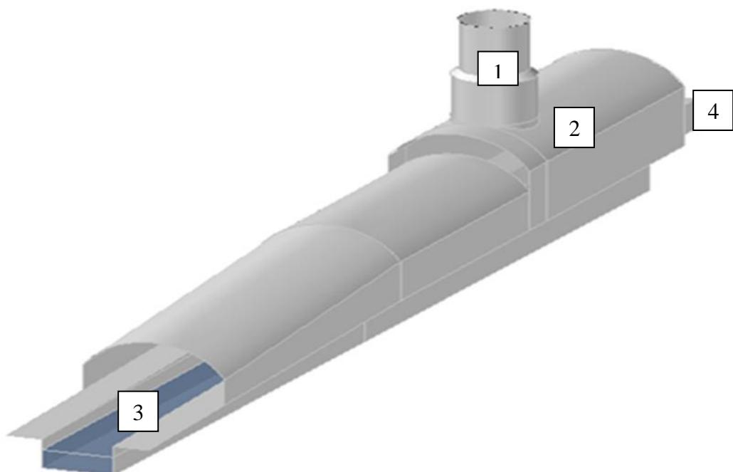
1-okno, 2-strojarnica, 3-odvodni kanal i 4- dovod.
