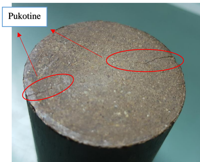
Slika 4-46. Pukotine uzrokovane maksimalnim ulaznim tlakom, uzorak 12.
