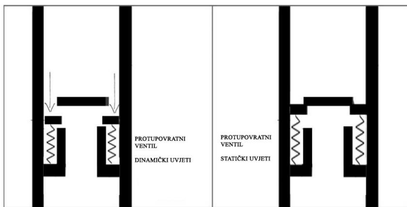
Slika 5-2. Princip rada protupovratnog ventila (Choe et al., 2007).
