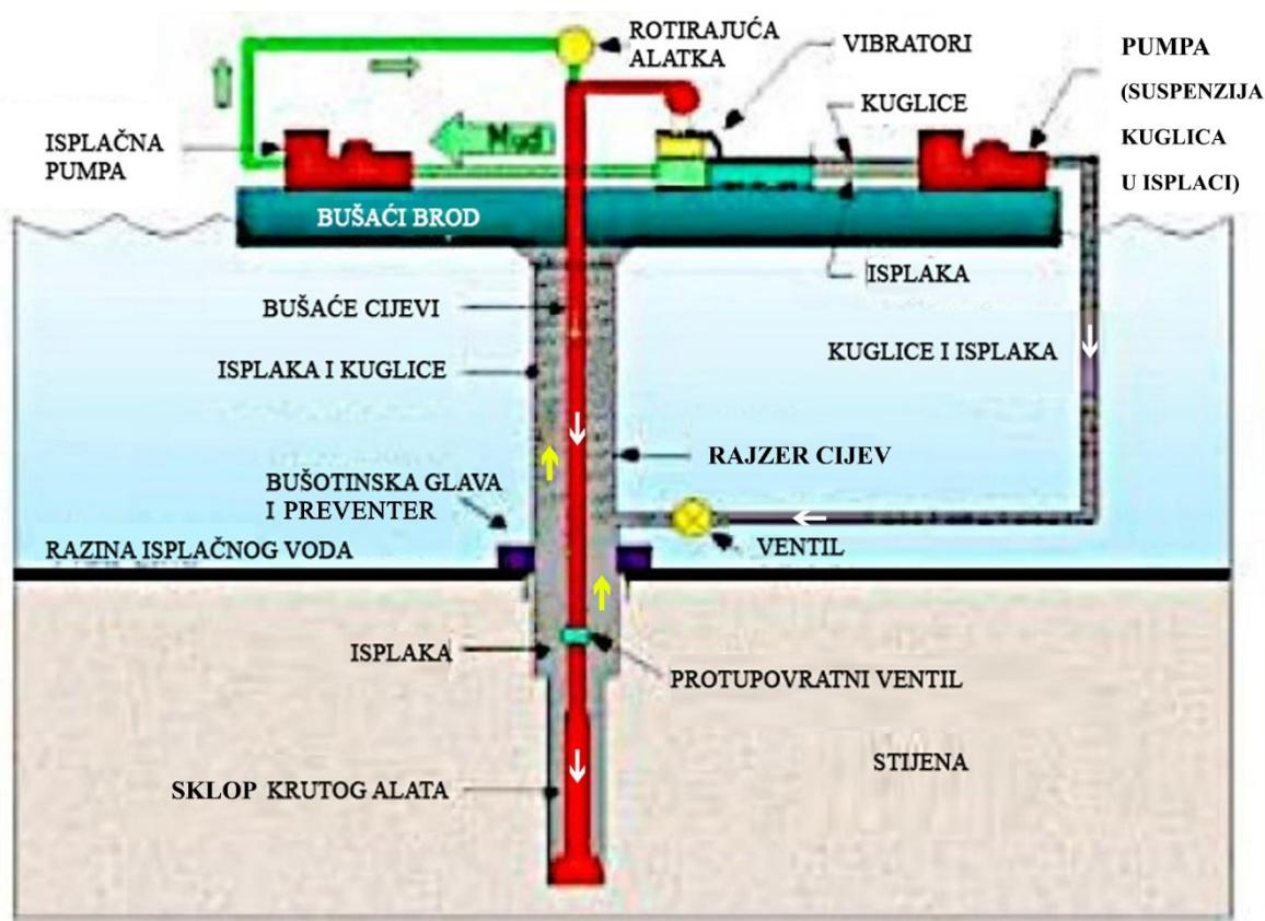
Slika 4-3. Metoda smanjenja hidrostatskog tlaka utiskivanjem suspenzije staklenih mikrokuglica u isplaci (Halkyard et al., 2014).
