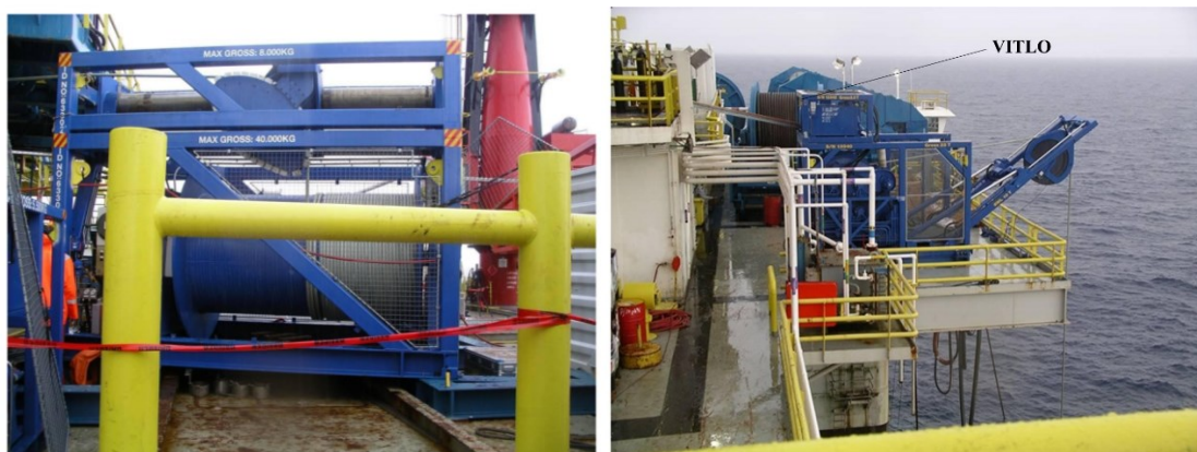
Slika 6-10. Vitlo nosivosti 25 t (lijevo) i vitlo nosivosti 10 t (desno) (Smith et al., 2010).
