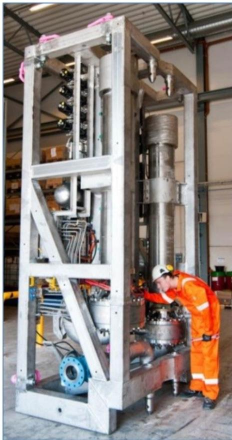
Slika 4-10. Podvodni pumpni modul (Rajabi et al., 2012).
