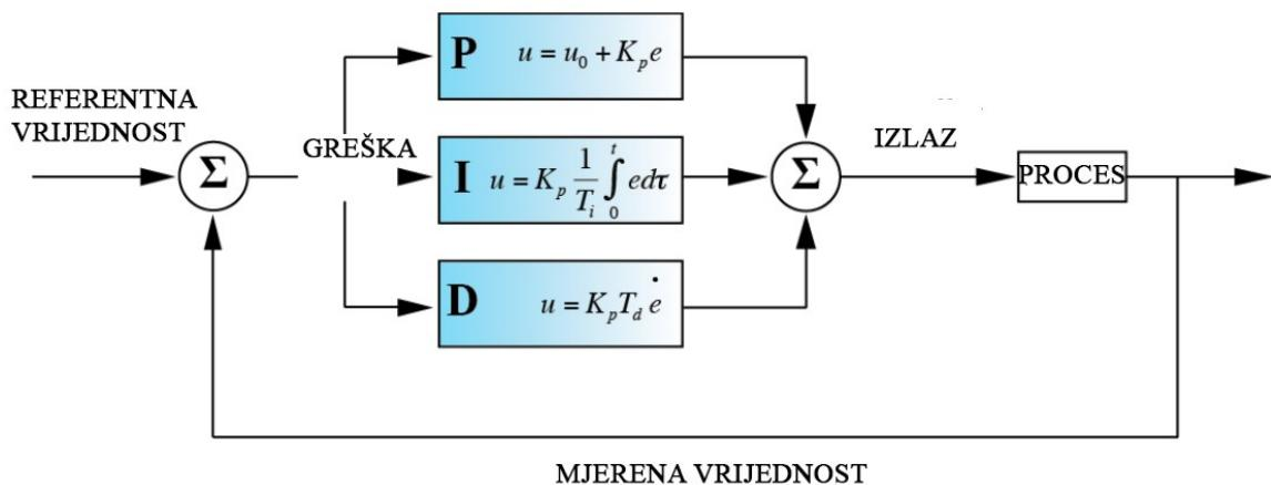
Slika 3-4. Način rada PID kontrolera (Güyagüler et al., 2009).
