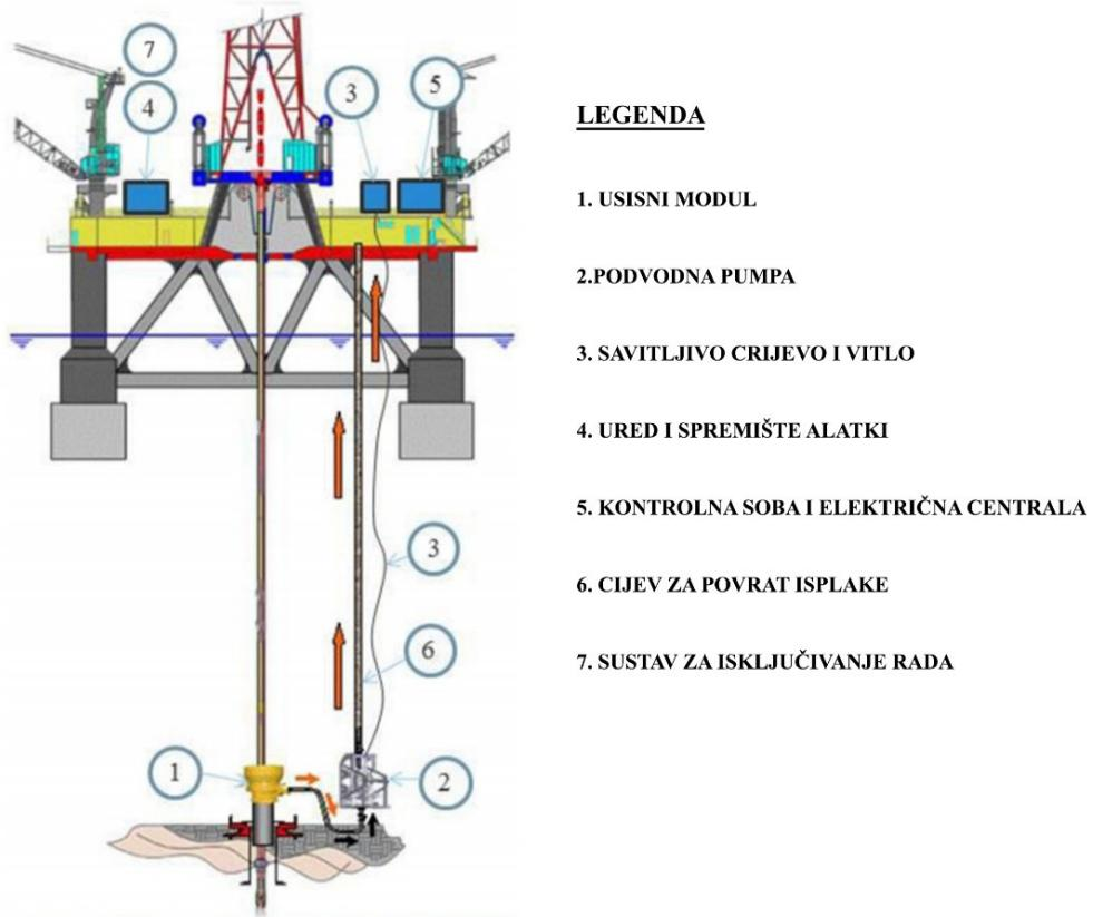
Slika 6-3. Glavni dijelovi metode povrata isplake bez rajzer cijevi (Stave, 2014).
