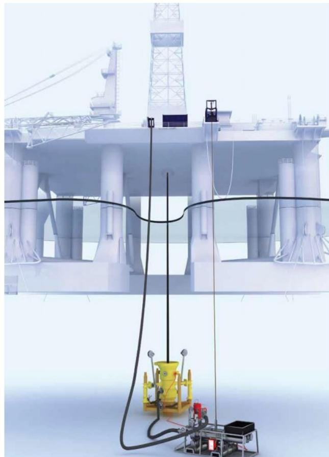
Slika 4-11. Metoda povrata isplake bez rajzer cijevi ([www.enhanced-drilling.com](http://www.enhanced-drilling.com)).
