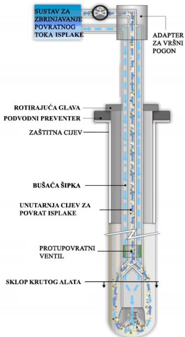
Slika 6-14. Način rada metode bušenja uz primjenu koncentričnog niza bušaćih šipki (Rajabi et al., 2010).
