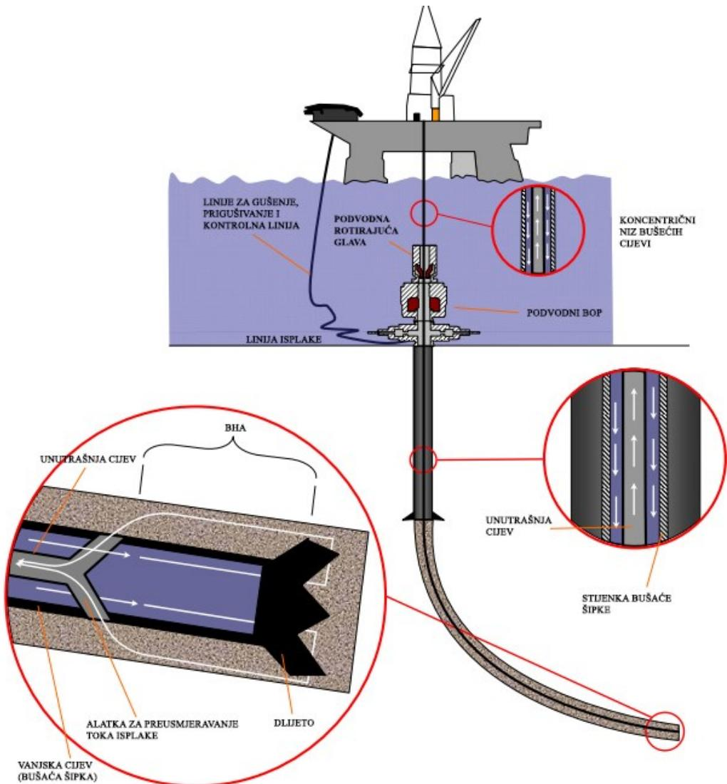
Slika 6-13. Metoda bušenja uz primjenu koncentričnog niza bušaćih šipki (Rajabi et al., 2010).
