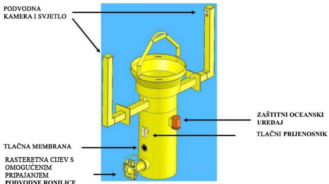
Slika 6-4. Sastavni dijelovi usisnog modula (Stave et al., 2014).
