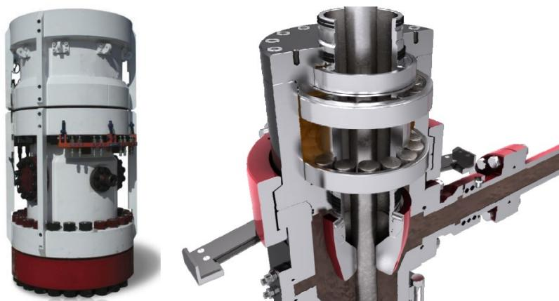
Slika 4-6. Povodni rotirajući preventer (Dowell, 2010; Saeed et al., 2012).
