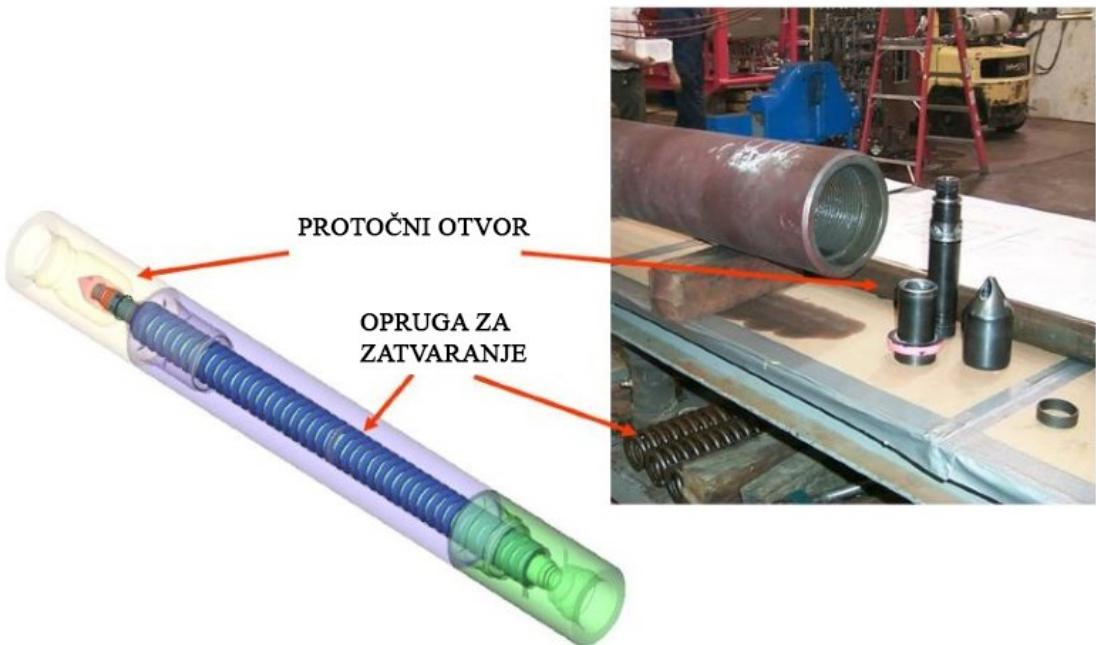
Slika 4-5. Protupovratni ventil za bušaće šipke (Dowell, 2010).
