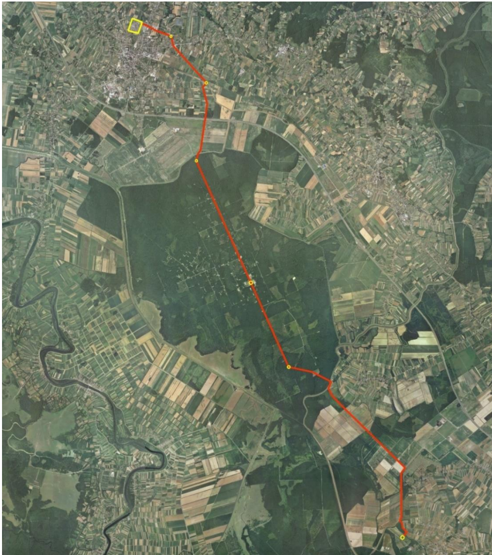
Slika 3-1. Planirana trasa transportnog cjevovoda DN 200
