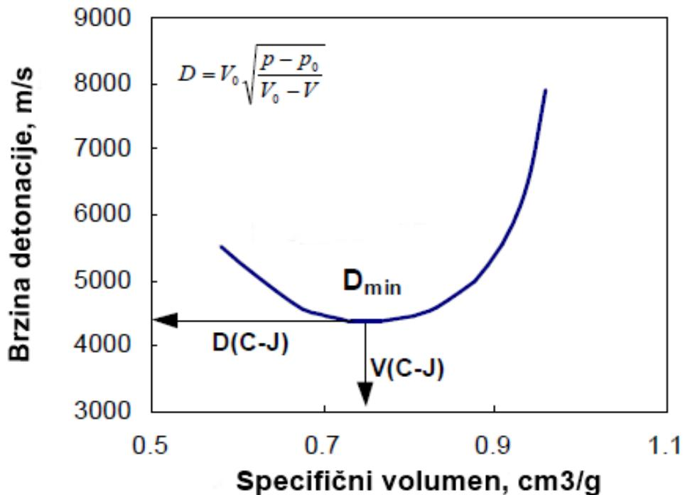
Slika 7-5. Promjene brzine detonacije pri specifičnom volumenu produkata detonacije (Sućeska, 2013)
