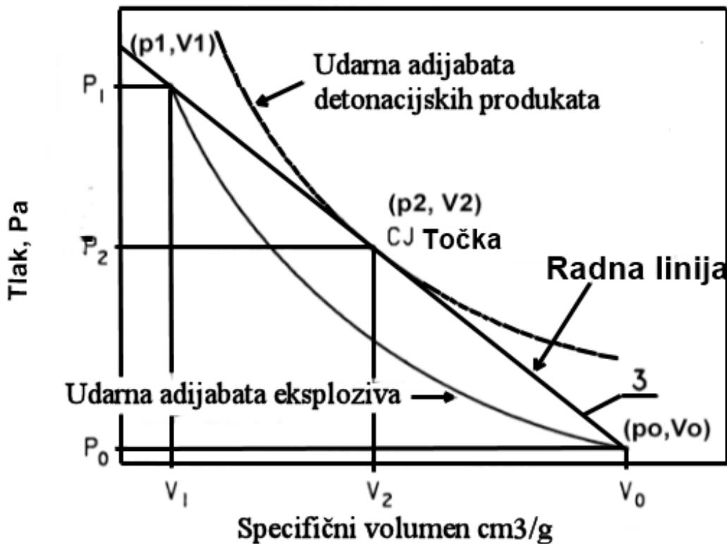
Slika 7-2. Udarna adijabata eksploziva i produkta detonacije u slučaju stalnih detonacija (Sućeska, 2013)
