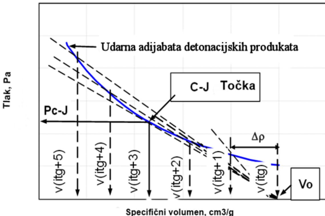
Slika 7-3. Determinacija C – J točke na udarnoj adijabati produkata detonacije (Sućeska, 2013)
