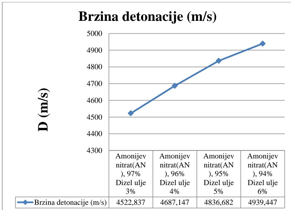
Slika 8-5. Brzina detonacije
