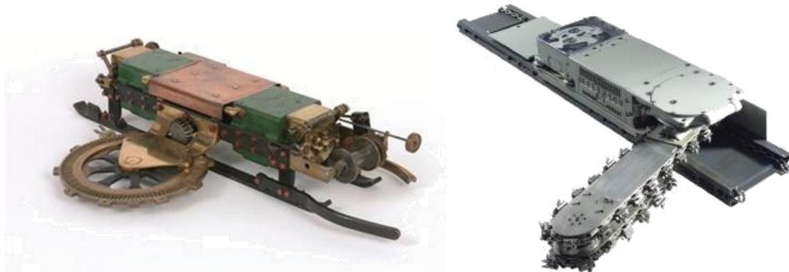
**Slika 2-1.** Podsjekačica s ozubljenim kotačem (lijevo) i s ozubljenim lancem (desno) (Kujundžić et al. 2003).
