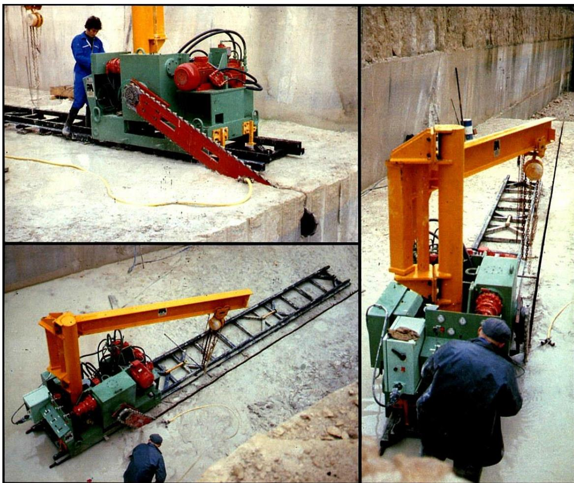
**Slika 2-2.** Lančana sjekačica francuske tvrtke Perrier pri piljenju horizontalnog reza u kamenolomu (Kujundžić et al. 2003).
