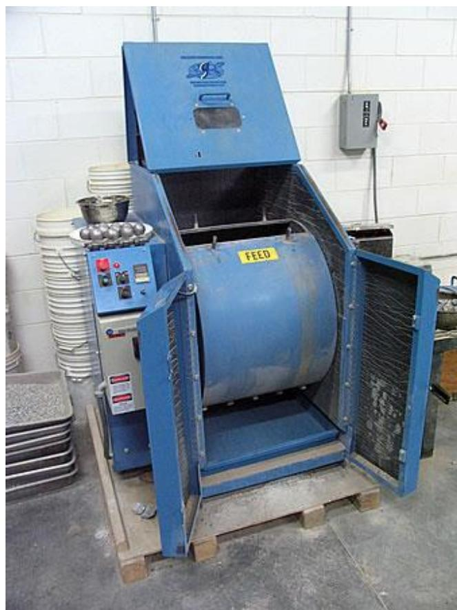
**Slika 4-1.** Rotirajući bubenj za ispitivanje abrazivnosti u sklopu LA metode (Pavia systems 2012).
