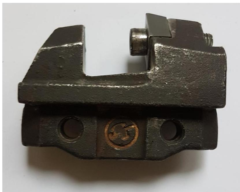
**Slika 6-11.** Nosač rezne pločice proizvodača Korfmann.
