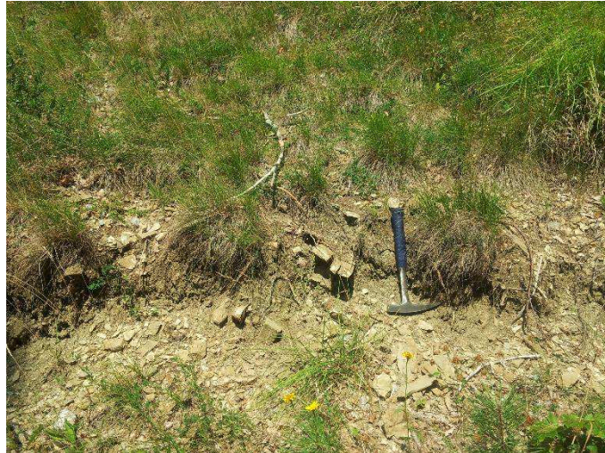
Slika 5-21. Izdanak lapora s proslojcima pješčenjaka podno južne litice Stražice. Točka D 148 .
