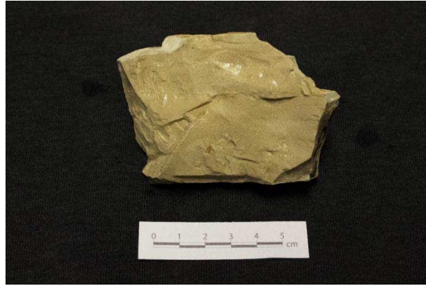
Slika 5-12. Uzorak smeđeg madstona nedefinirane jedinice Gornji kalciiferski vapnenac.
