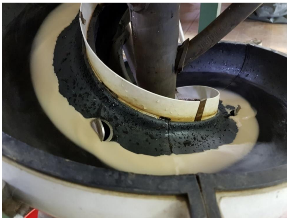
Slika 4-14 Ispitivanje na spiralnom žlijebu – bliži prikaz
