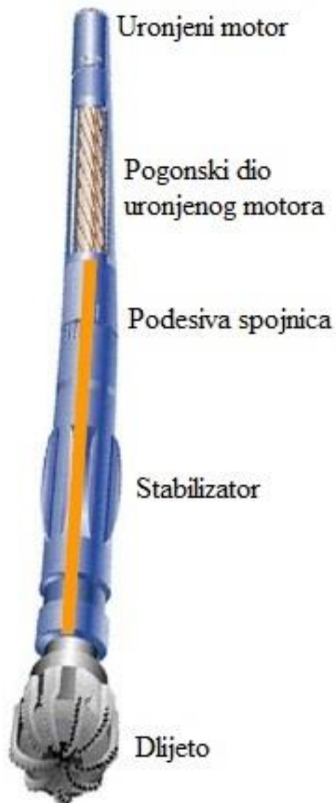
Slika 2-1. Primjer upravljivog sustava (Gaurina-Međimurec, 2015)
