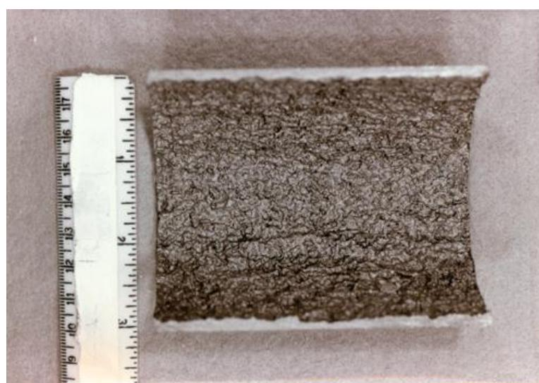
Slika 4-2. Rupičasta korozija (Pipeliner Indonesia, 2016)
