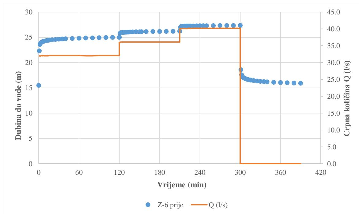
**Slika 4.1.** Prikaz razine vode i crpne količine u zdencu Z-6 tijekom pokusnog crpljenja prije provedene revitalizacije
