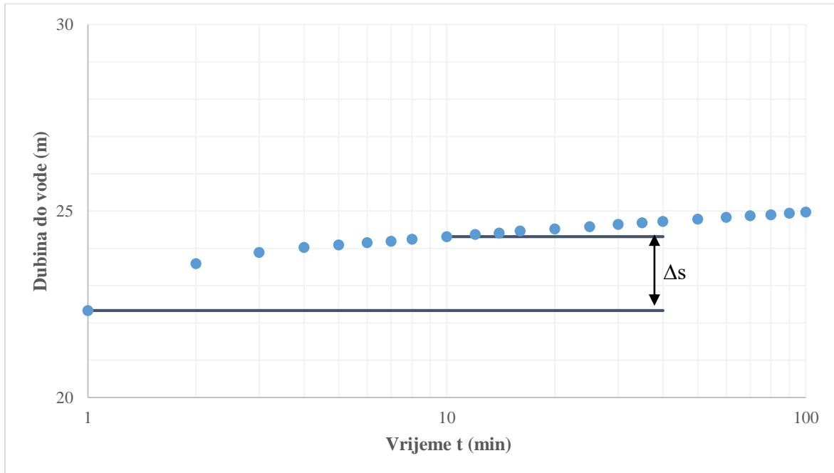
**Slika 4.2.** Polilogaritamski dijagram sniženja u vremenu za prvu crpnu količinu pri pokusnom crpljenju zdenca Z-6 prije provedene revitalizacije
