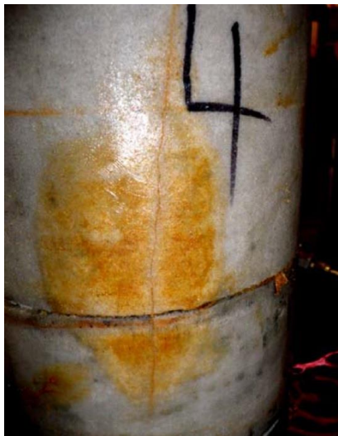
Slika 2-2. Prikaz vertikalnih i horizontalnih pukotina na uzorku stijene (Nwaoji et al., 2013)
