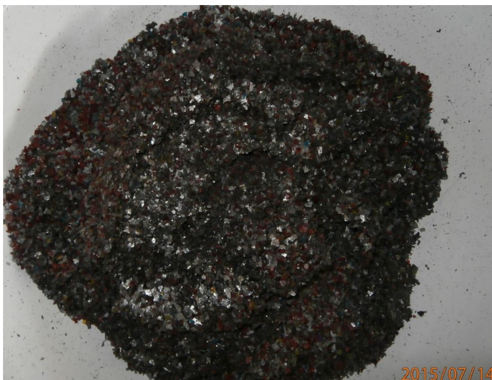
Slika 3-13. Materijal nakon reznog mlina
