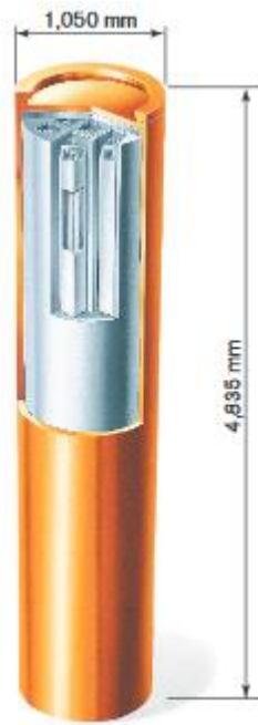
Slika 3—13 Prikaz bakrenog spremnika dizajniranog od strane Švedskog SKB (SKB, 2010.)
