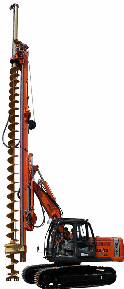
Slika 3-6 Stroj za izradu pilota s kontinuiranim svrdlom Geax EK90 (Piling Equipment Ltd., 2018)
