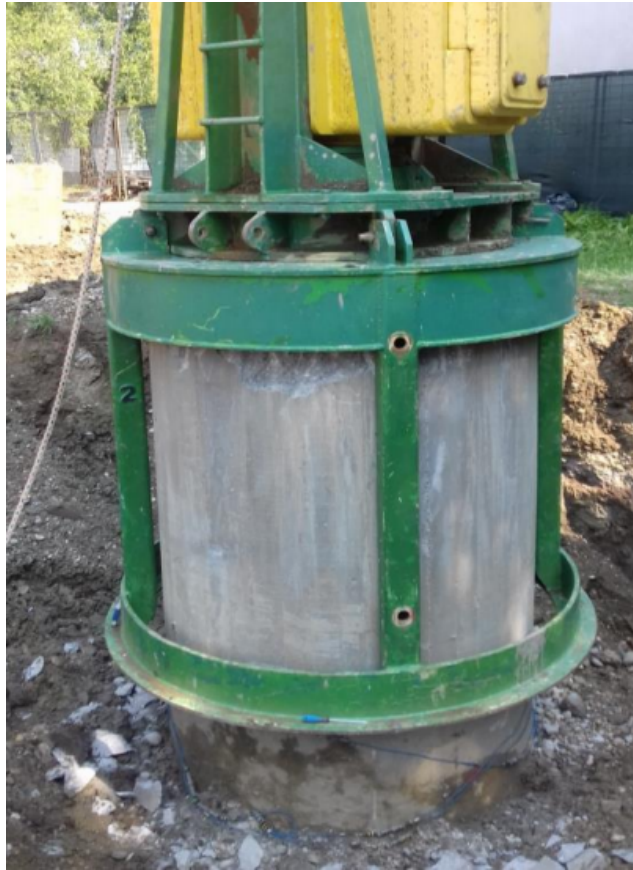
Slika 6-2 Glava pilota s utegom i ugrađenim sensorima (Matković, 2017)
