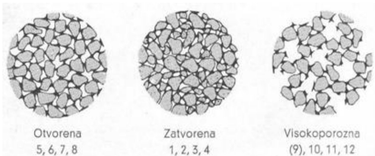
Slika 7. Struktura brusnih ploča
