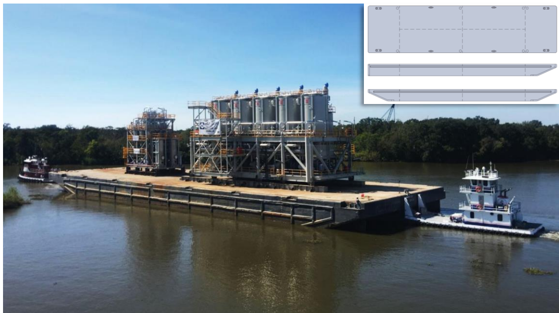
Slika 2.4. Deck barge – teretna barža [3].
