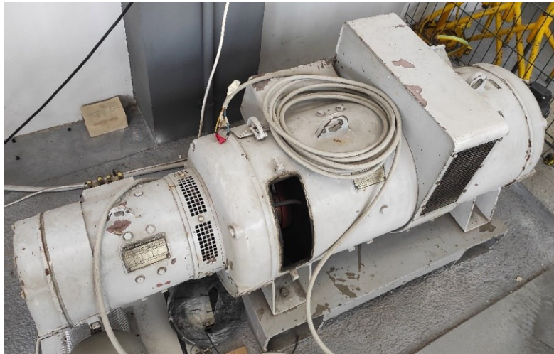
Slika 4.5. Laboratorijski asinkroni stroj 26kW
