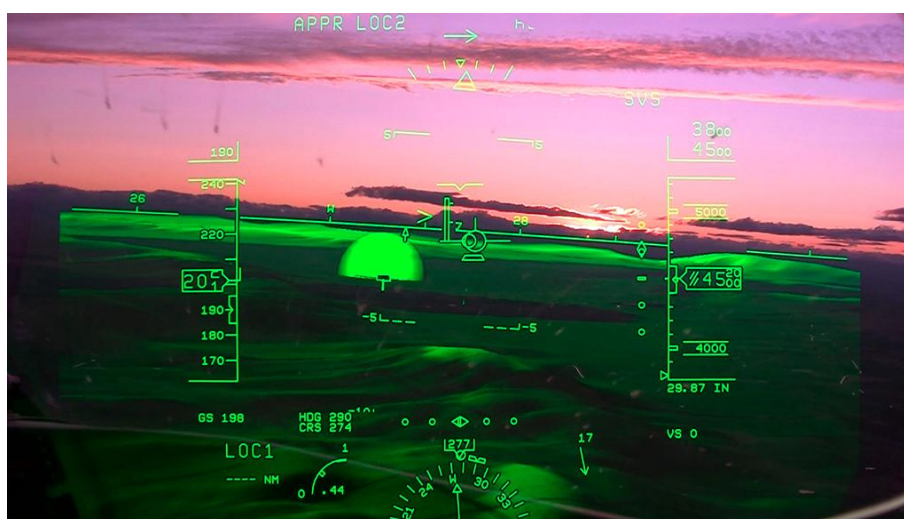
Slika 2.6 Hibridni sustav sintetičkog vida
