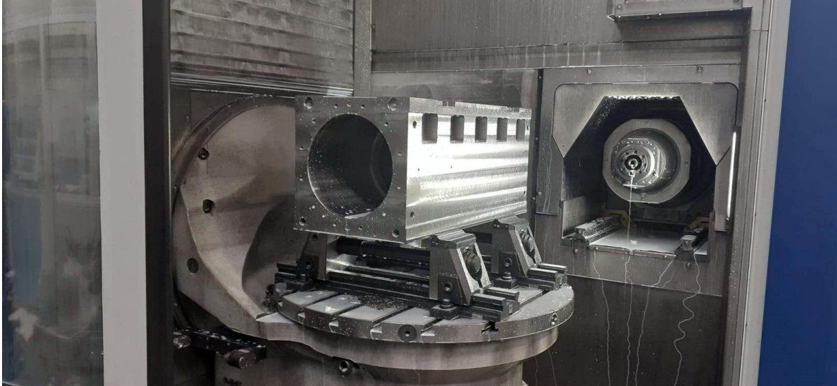
Slika 2.3. Glodanje na obradnom centru GROB
