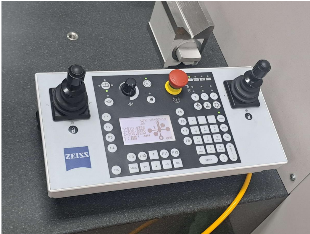
Slika 4.12. Upravljač trokoordinatnog mjernog uređaja
