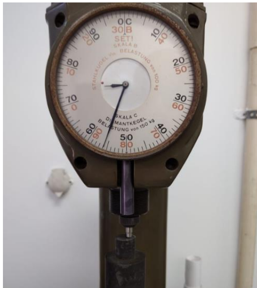
Slika 6.6. Tvrdoća strojnog dijela nakon kaljenja
