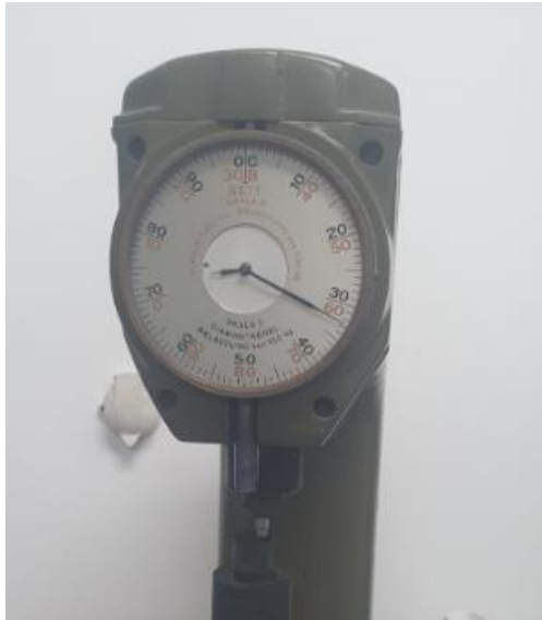
Slika 6.7. Tvrdoća strojnog dijela nakon popuštanja
