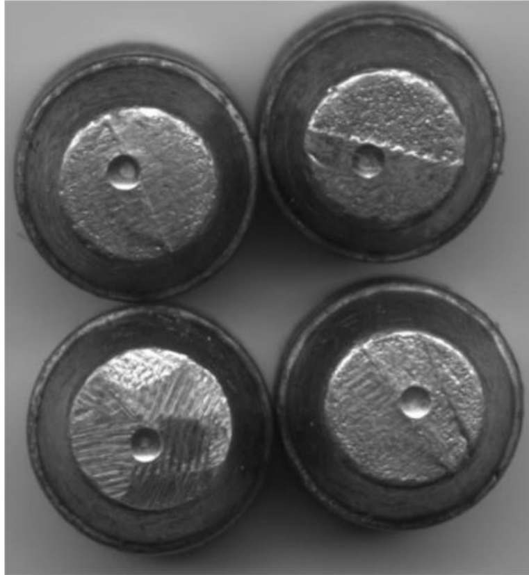
Slika 6.3. Uzorci nakon ispitivanja tvrdoće metodom po Brinellu [18]
