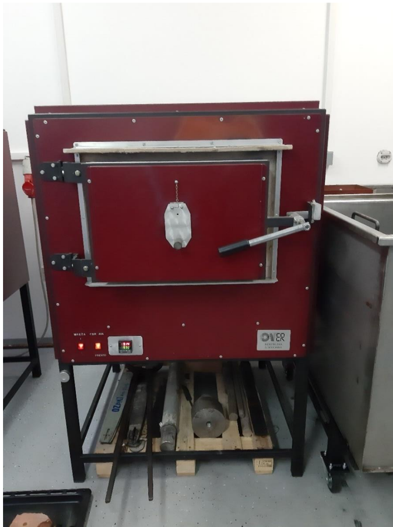
Slika 7.5. Peć korištena u postupku cementiranja
