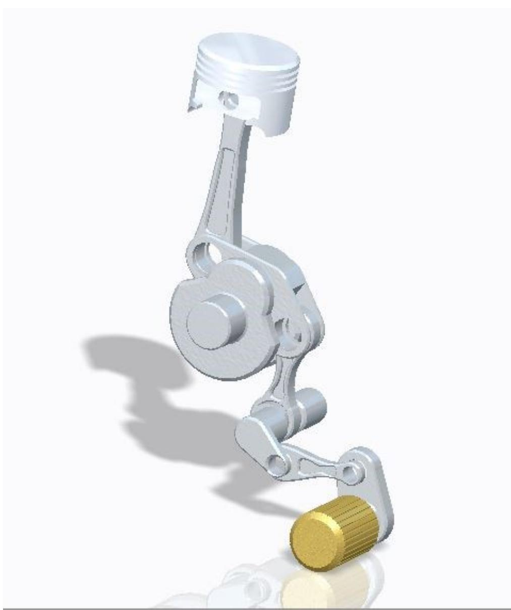
Slika 7.1 3D model sustava promjene kompresije
