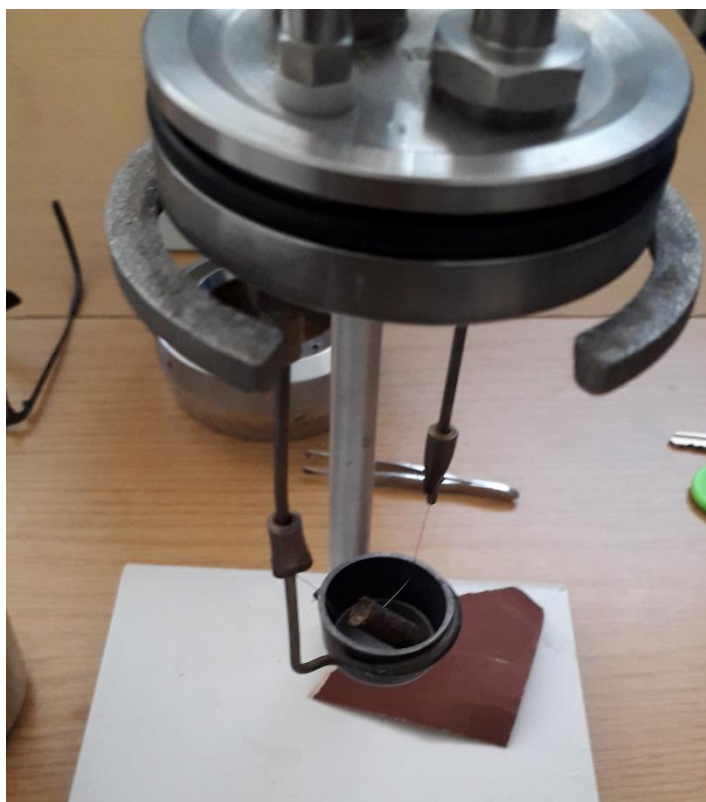
Slika 7.14 Priprema peleta za određivanje ogrjevne moći
