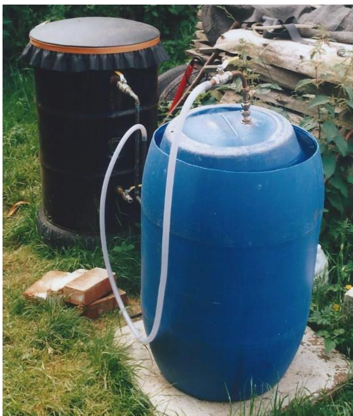
Slika 3.4 Bioplinsko postrojenje domaće izrade [12]
