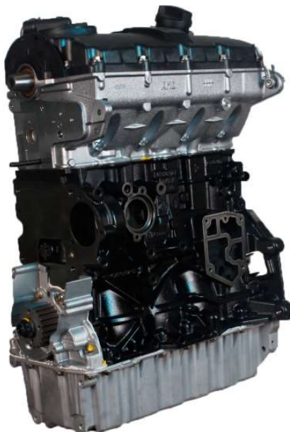
Slika 6.1. VW dizelski motor (Inline 4) [23]
