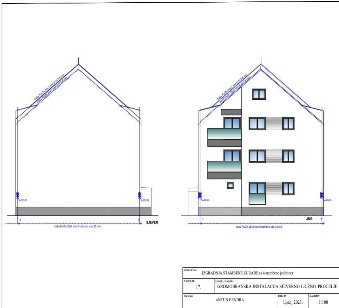
Slika 7.2 Prikaz gromobranske instalacije pročelja
