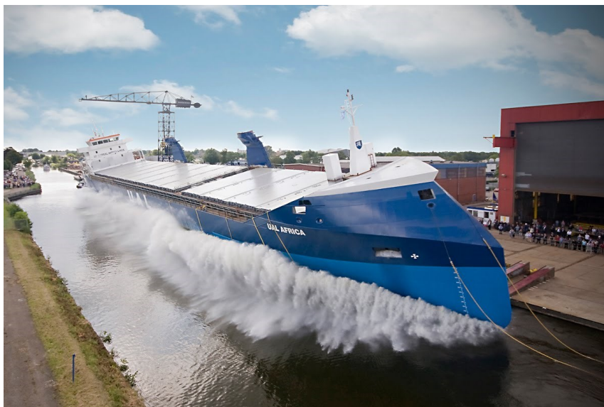
Slika 6.2. Poprečno porinuće na kosom navozu
