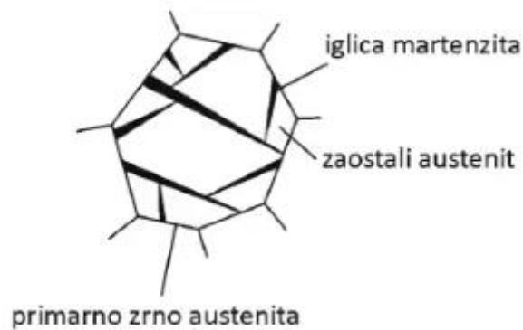
Slika 3.7. Rast iglica martenzita [3]
