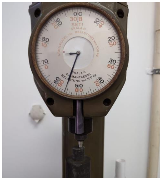
Slika 6.6. Tvrdoća strojnog dijela nakon kaljenja
