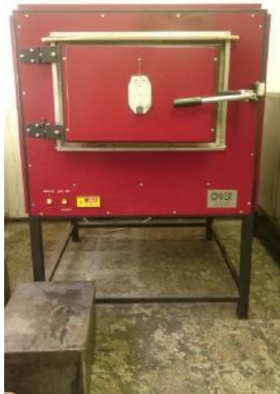
Slika 6.5. Komorna peć OVER snage 12 kW
