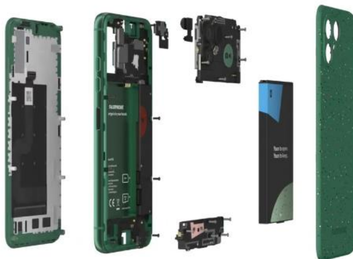
Slika 3.1 Modularni dizajn Fairphone-a 4[22]
