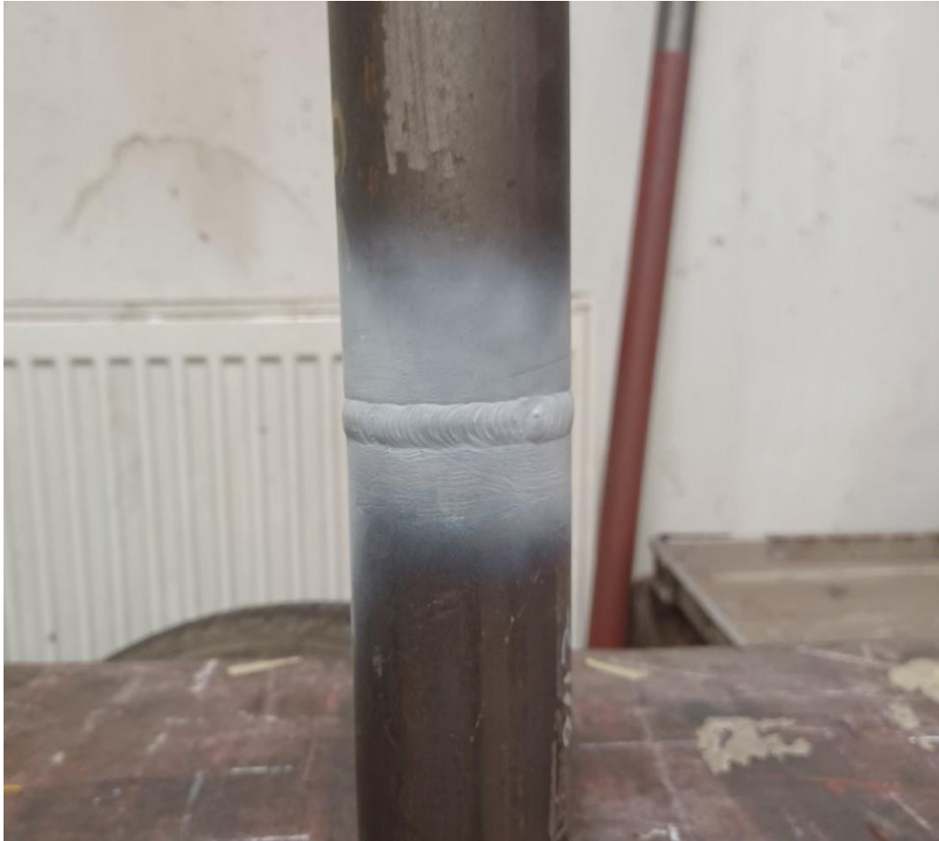
Slika 5.9. Prikaz razvijača nakon isteka vremena razvijanja
