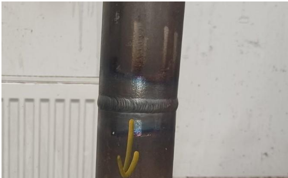
Slika 5.1. Prikaz zavarenog spoja strojnog dijela OT.24-SI.50
