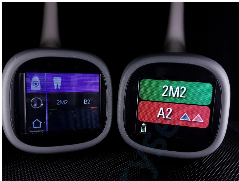
Slika 23. Usporedba rezultata mjerenja boje zuba 22 VITA Easyshade V (lijevo) i VITA Easyshade LITE (desno) spektrofotometrom
