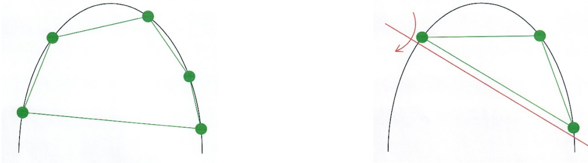
Slika 3. i 4. Poligonalni i trokutasti raspored opterećenja. Preuzeto iz (4), ljubaznošću prof.dr.sc.Ketij Mehulić.
