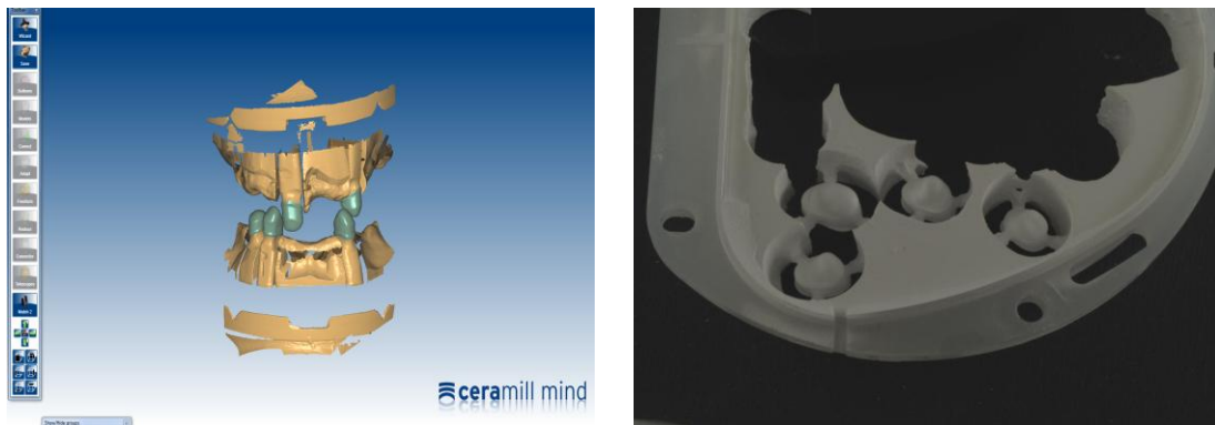
Slike 24 i 25. Softversko oblikovanje i glodanje primarnih konus krunica iz bloka cirkonijoksidne keramike
