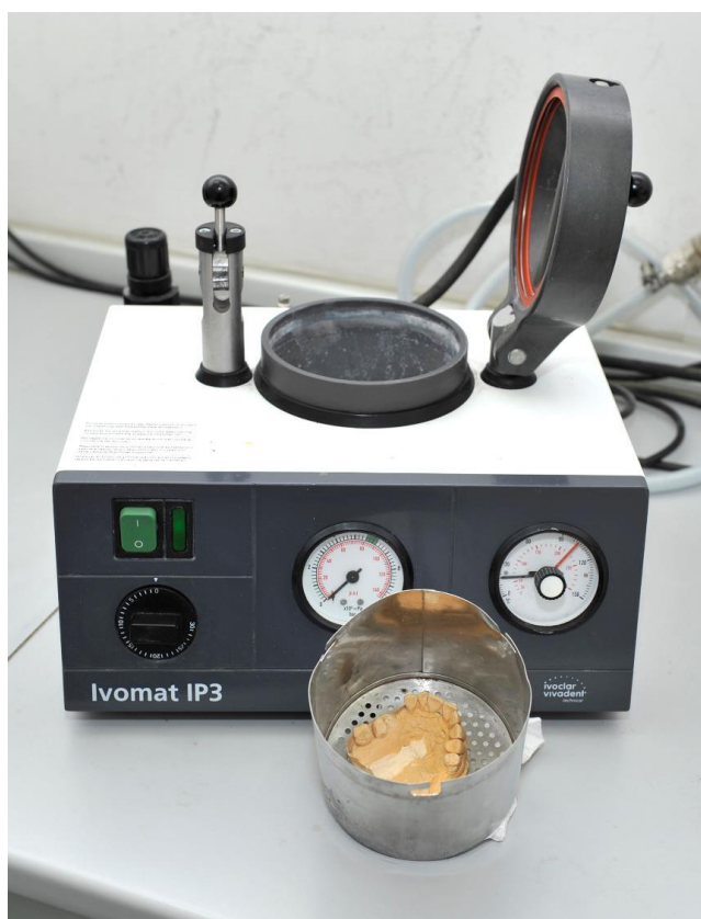
Slika 17. Uređaj za toplinsko tlačnu polimerizaciju akrilata
