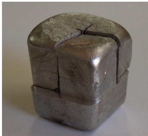
Slika 51. Izrezani odljevak iz Croning lončića
