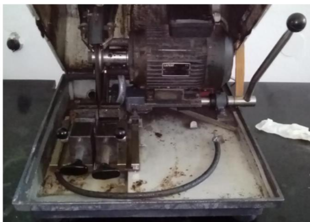
Slika 52. Rezalica Buehler za izradu uzoraka
