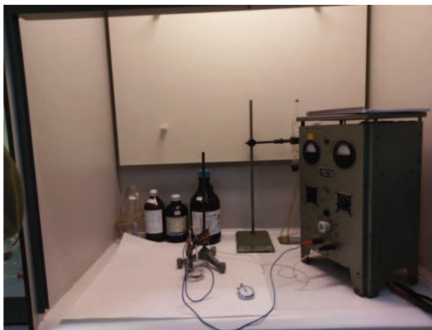
Slika 34. Elektrolitičko nagrivanje uzoraka (aparatura)
