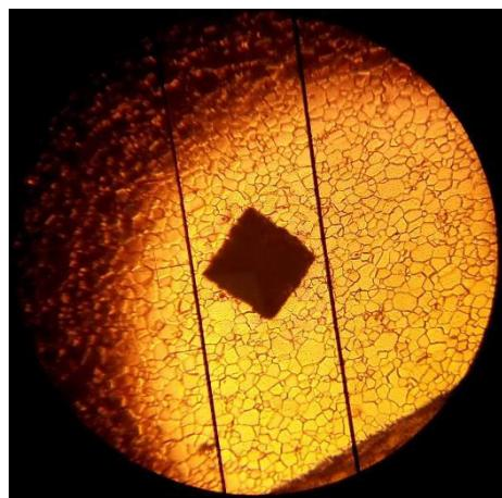
Slika 33. Otisak pri mjerenu makro-tvrdoće uređajem
