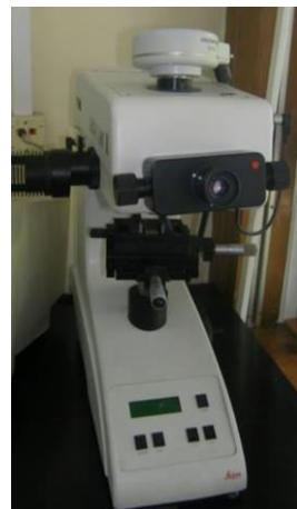
Slika 25. Mikro-tvrdomjer LEICA VMHT
