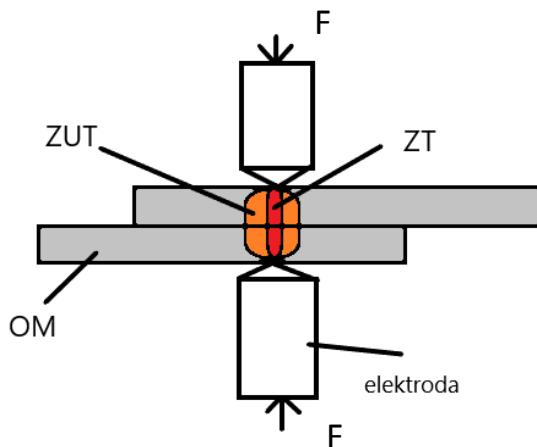
Slika 15. Prikaz zona varanja prilikom točkastog zavarivanja
