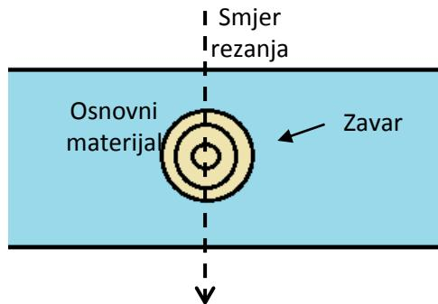
Slika 21. Mjesto rezanja uzorka za strukturalna ispitivanja i mjerjenje tvrdoće
