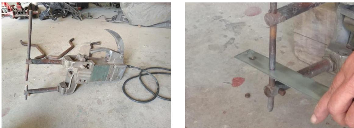
Slika 18. Aparat za zavarivanje i zavarivanje limova
