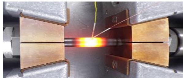
Slika 10. Difuzijsko zavarivanje u vakuumu [10]
