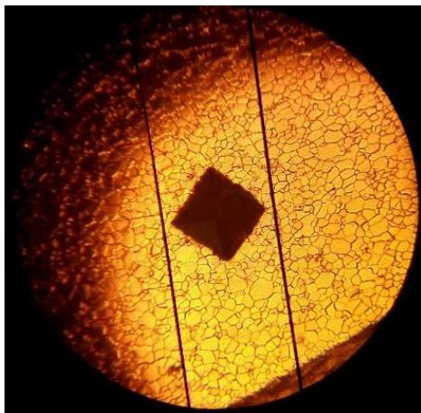
Slika 24. Mjerenje makro-tvrdoće
