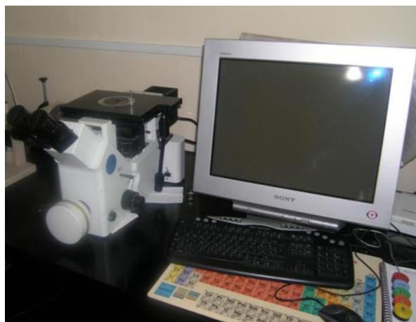
Slika 22. Invertni metalografski mikroskop Olympus GX 71
