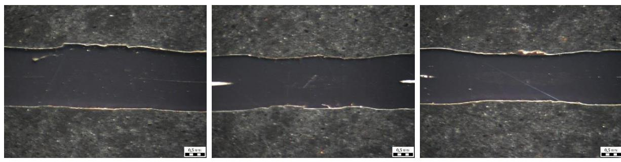
Slika 32. Udubljenja u području zavara uslijed djelovanja sile elektroda
