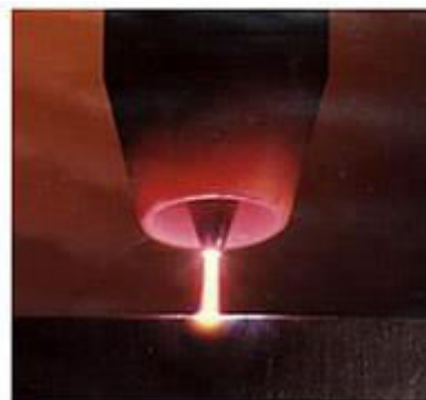
Slika 7. Zavarivanje plazmenim lukom [6]
