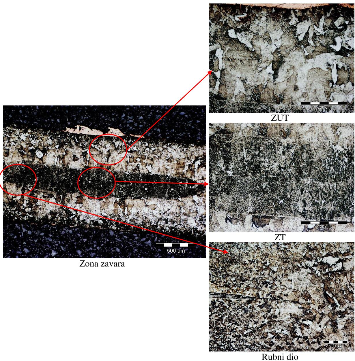
Slika 29. Zona taljenja i zona utjecaja topline u zavaru uzorka iz trake uzimane s vozila Toyota
