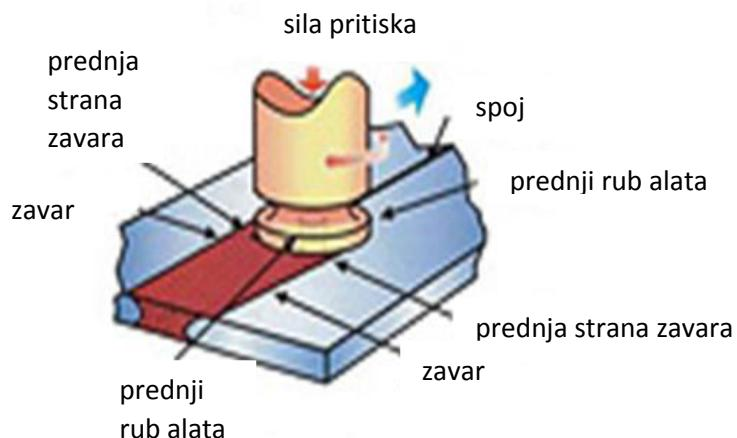
Slika 8. Zavarivanje trenjem s okretnim alatom [6]
