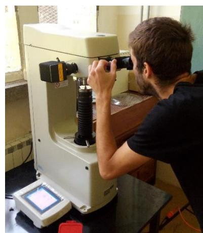
Slika 23. Ispitivanje makro-tvrdoće u području zavara
