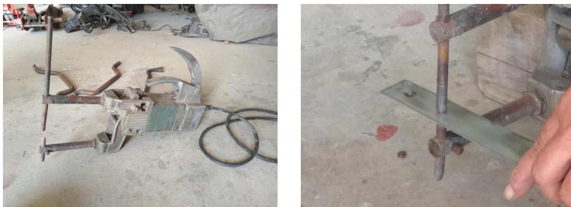
Slika 18. Aparat za zavarivanje i zavarivanje limova
