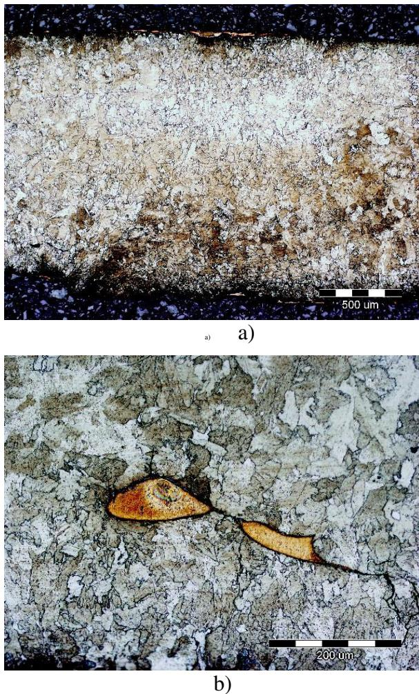
Slika 27. Zona taljenja i zona utjecaja topline u zavaru uzoraka iz trake uzimane s vozila Opel: a) Područje zavara, b) Uključak bakra
