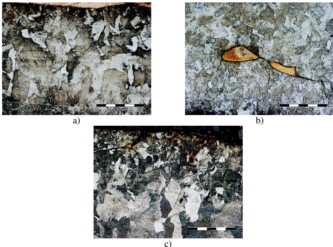
Slika 30. Uključci bakra nastali tijekom zavarivanja limova
