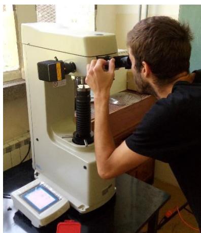
Slika 23. Ispitivanje makro-tvrdoće u području zavora
