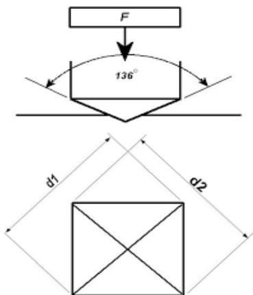
Slika 16. Otisak vrha piramide pri mjerenu tvrdoće po Vickersu [21]
