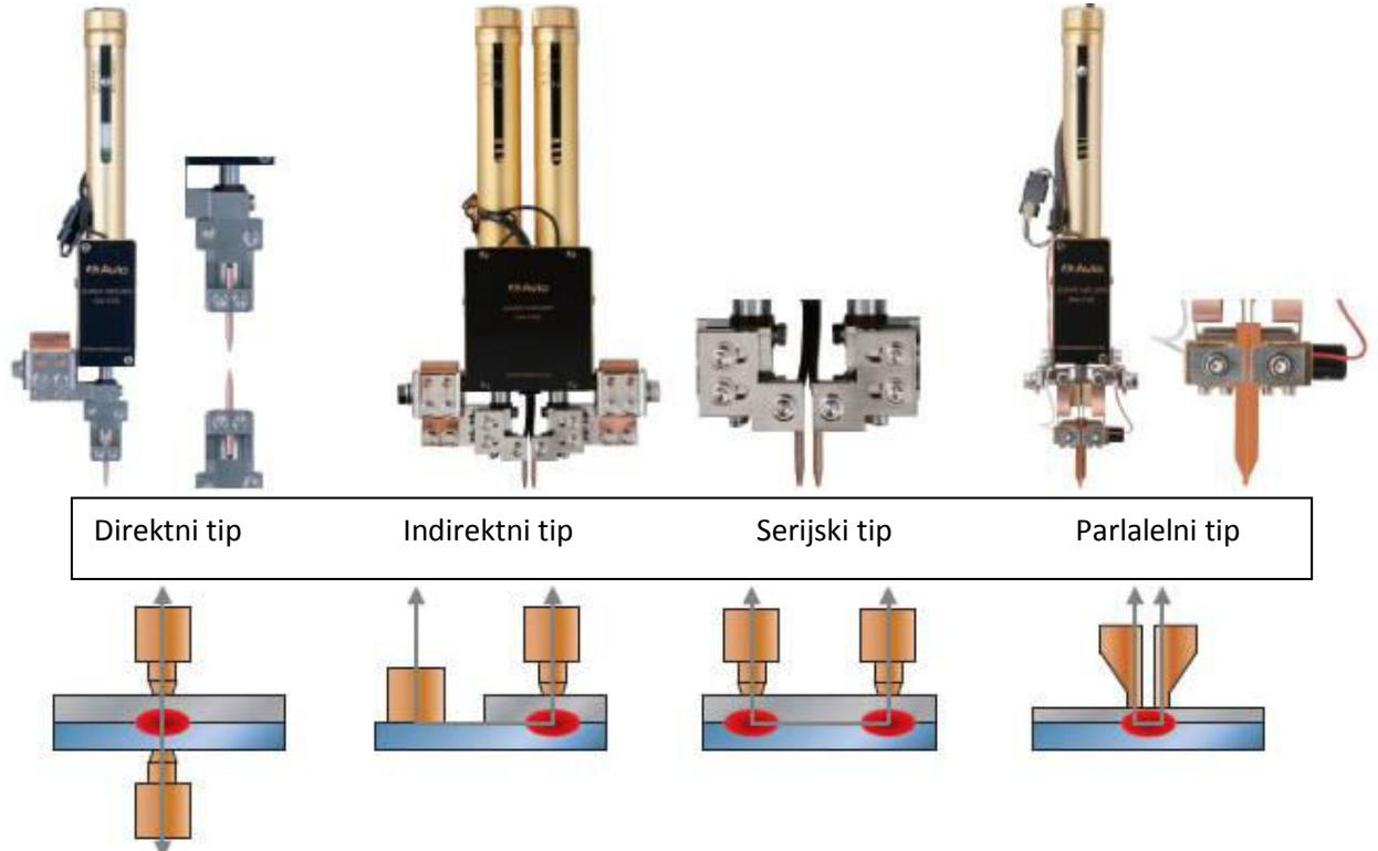
Slika 13. Postupci točkastog elektrootpornog zavarivanja [15]
