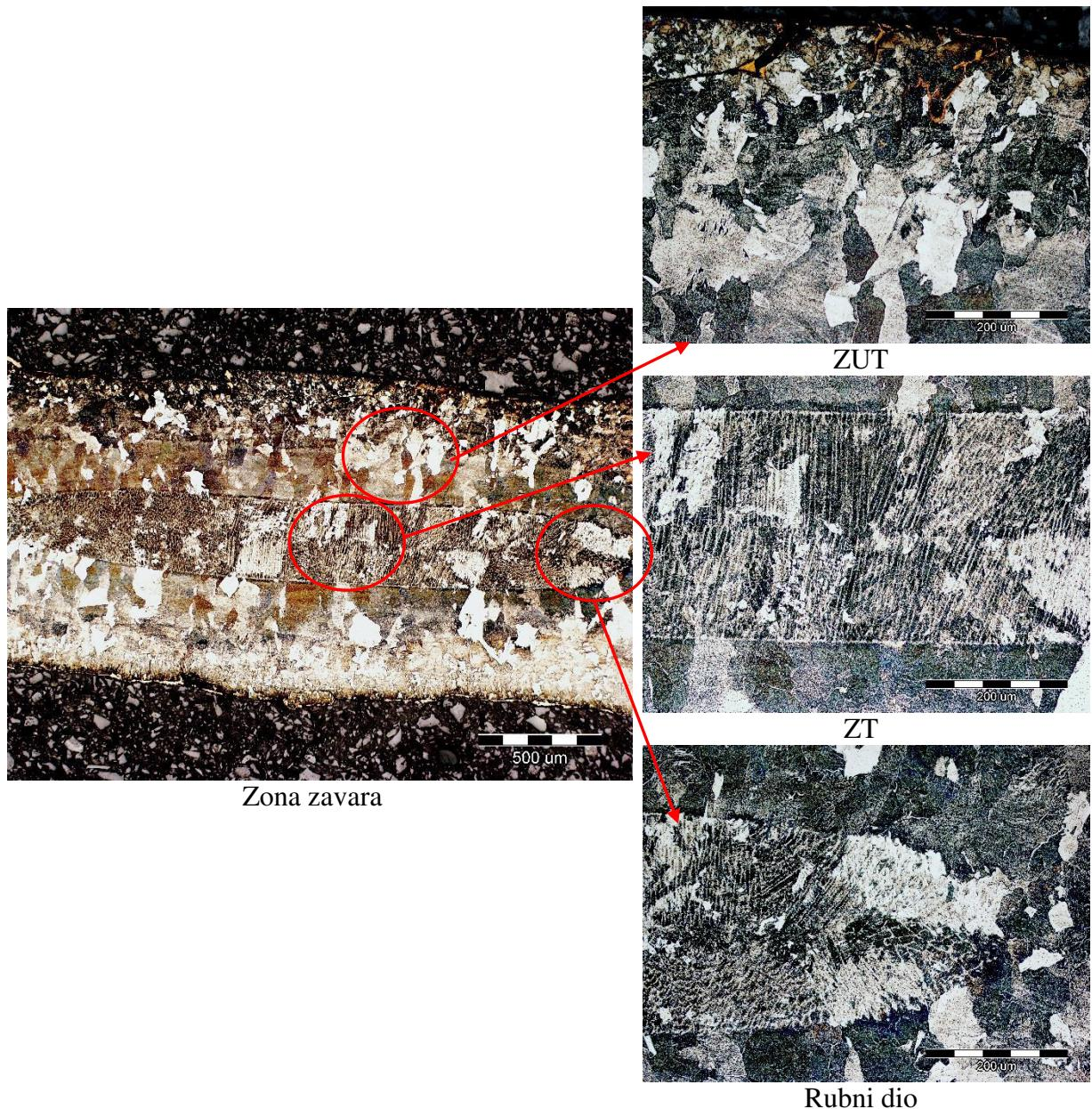
Slika 28. Zona taljenja i zona utjecaja topline u zavaru uzorka iz trake uzimane s vozila Peugeot
