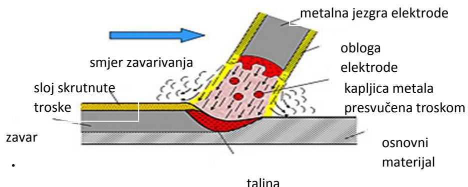
Slika 4. Shema električnog luka s obloženom taljivom elektrodom [6]
