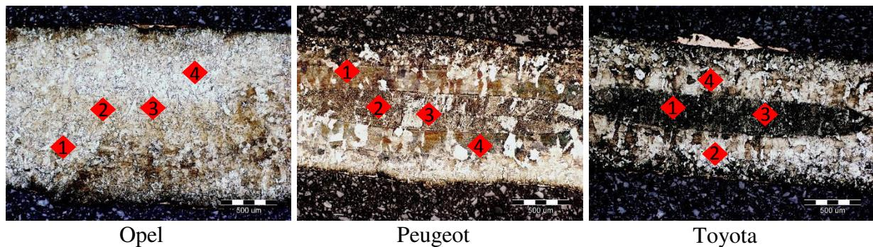
Slika 34. Mjesto mjerena makro-tvrdoće na sva tri zvara
