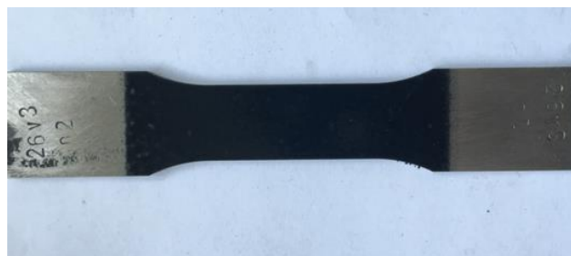
Slika 30. Uzorak nakon nanošenja crnog mat premaza
