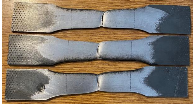
Slika 39. Uzorci nakon statičkog vlačnog ispitivanja kut 0^\circ
