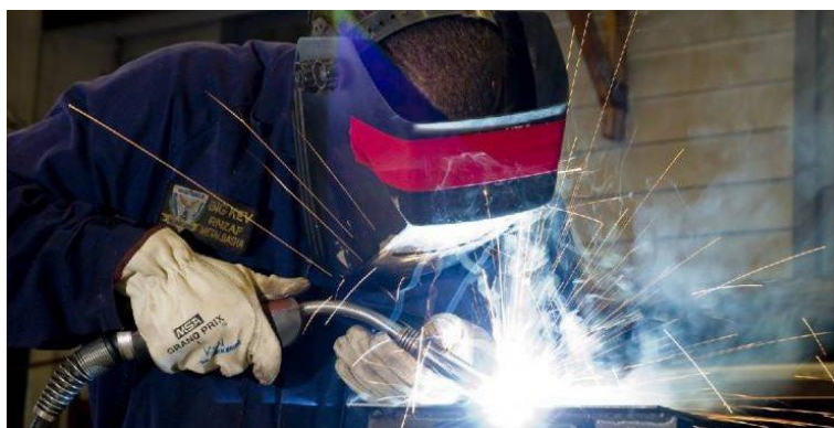
Slika 1. Primjena MIG postupka zavarivanja [3]
