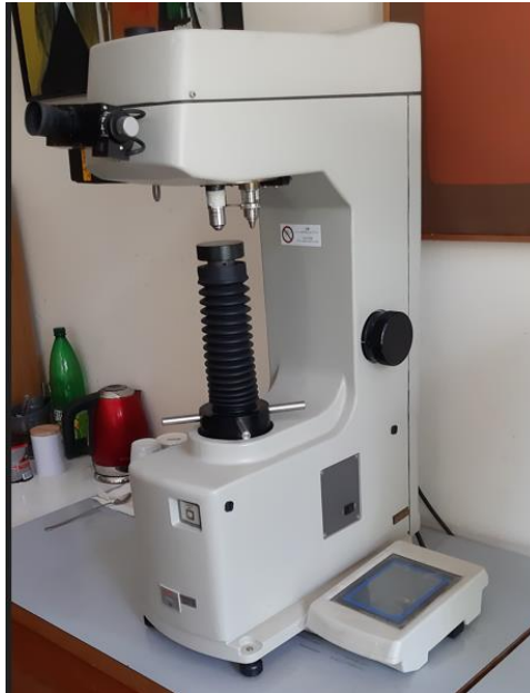
Slika 25. Uređaj Mitutoyo za mjerenje tvrdoće metodom po Vickersu
