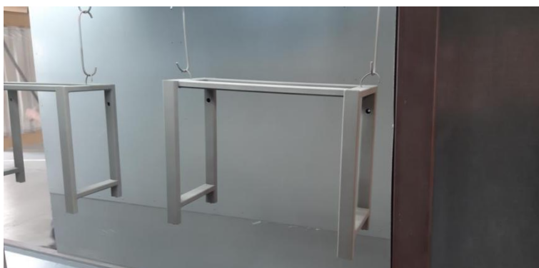
Slika 2. Sušenje zavarenog čeličnog stolića MIG metodom nakon nanošenja zaštitnog premaza
