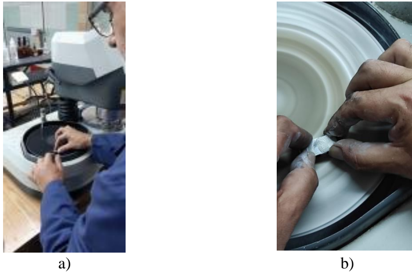
Slika 22. Priprema za metalografsku analizu: a) brušenje i b) poliranje
