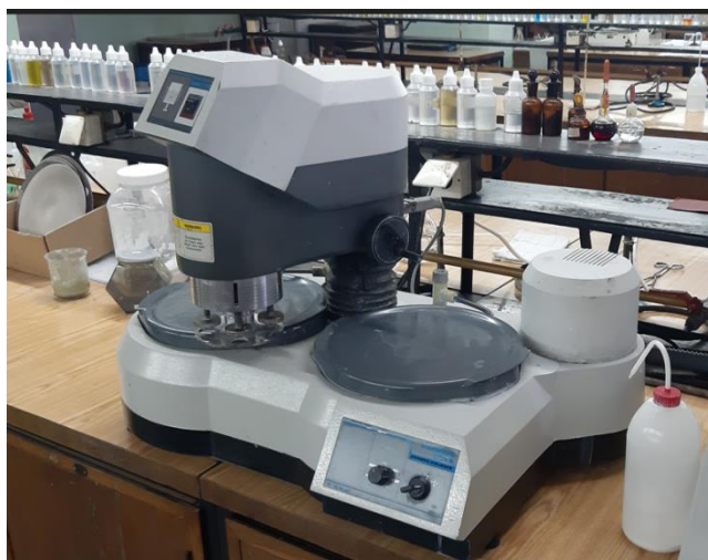
Slika 21. Uređaj za brušenje i poliranje “BUEHLER Phoenix Beta”
