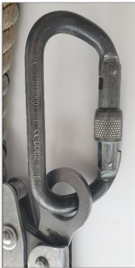
Slika 18. Spojni element tzv. Karabiner s maticom
