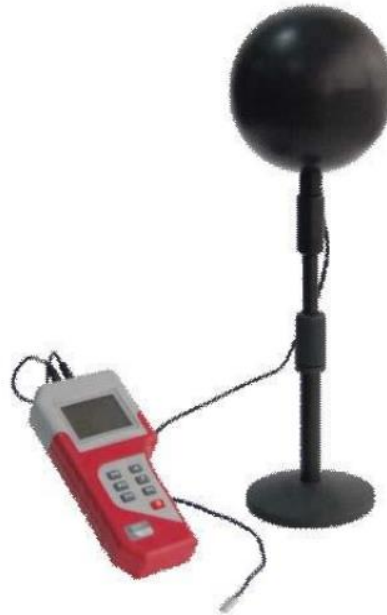
Slika 5. Globus termometar za mjerenje temperature zračenja plohe [11]
