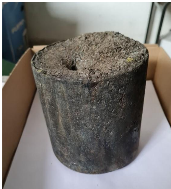
Slika 21. Ingot CuAlMnZr SMA legure
