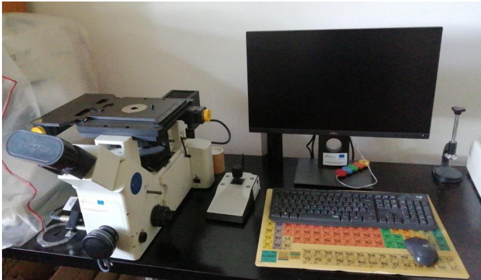
Slika 30. Svjetlosni mikroskop Olympus GX51
