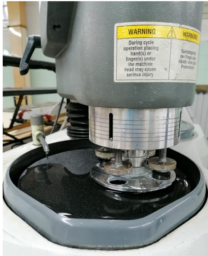
Slika 28. Uređaj za brušenje i poliranje
