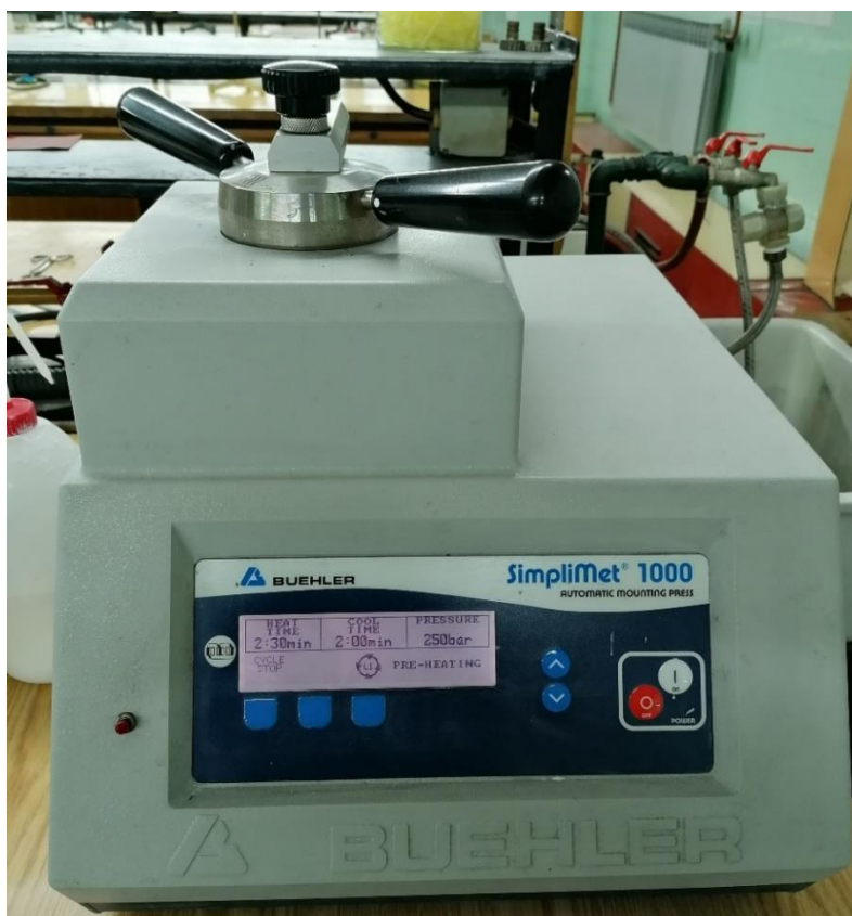
Slika 27. Uređaj BUEHLER SimpliMet 1000 za vruće prešanje
