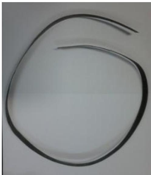
**Slika 21.** Fotografija Cu-Al-Mn hladno valjane trake debljine 1,02 mm
