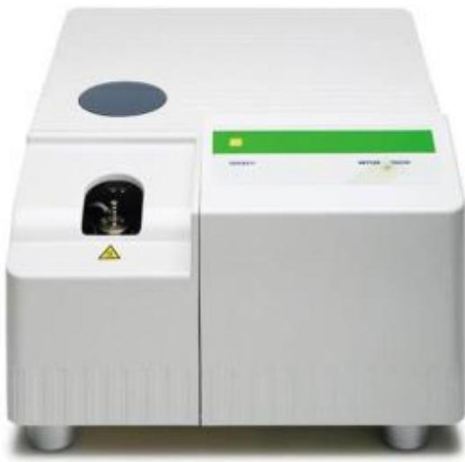
**Slika 31.** Fotografija diferencijalno skenirajućeg kalorimetra Mettler Toledo 822e
