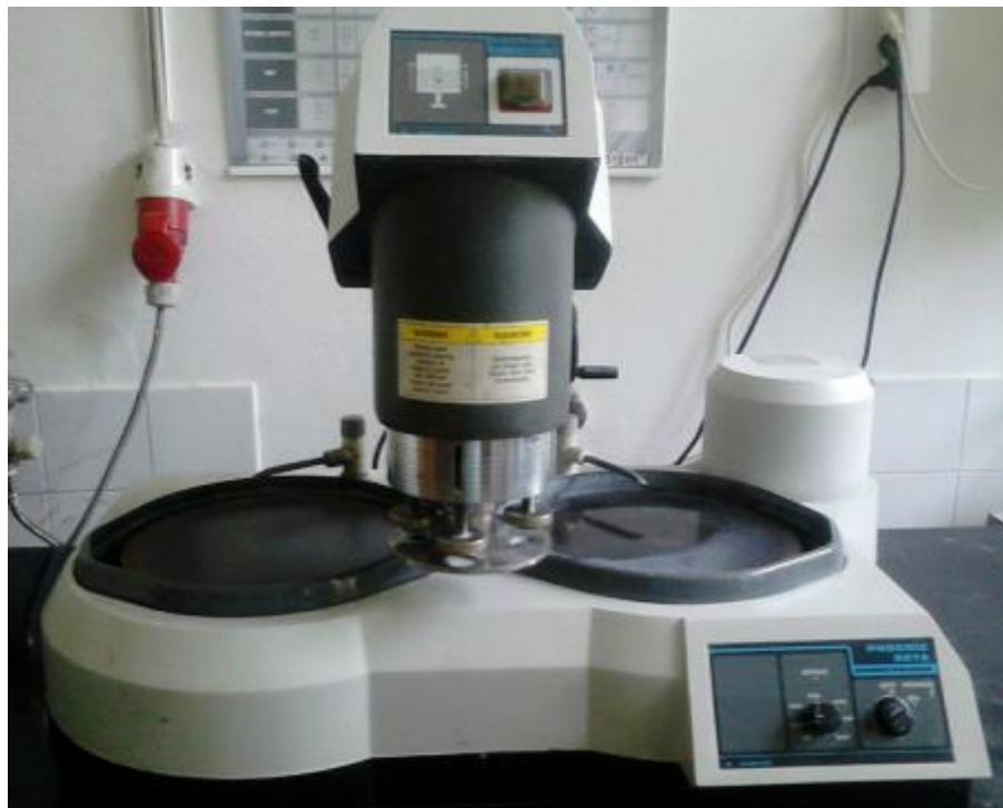
**Slika 25.** Fotografija uređaja za brušenje Buehler „Phoenix beta“
