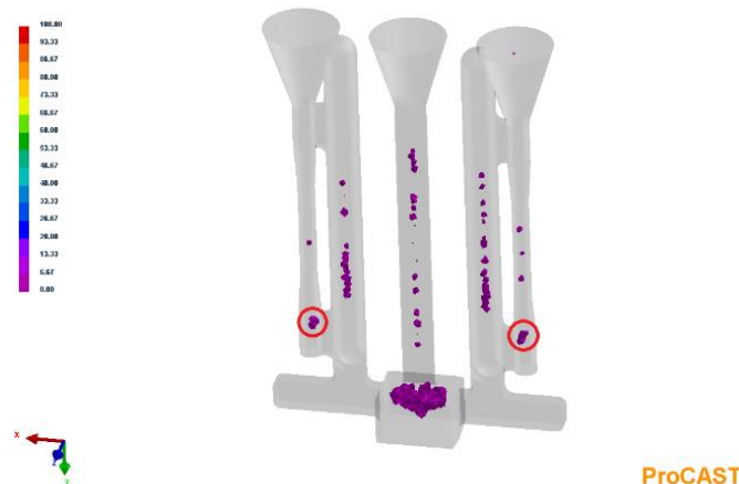
Slika 61. Prikaz poroznosti unutar ProCAST programa
