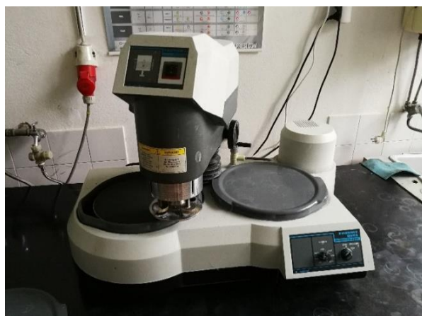
Slika 54. Uređaj za brušenje i poliranje Vektor LC proizvođača Buehler
