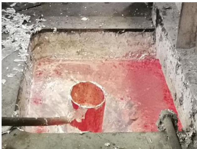
Slika 40. Lonac za talinu spojen s peći
