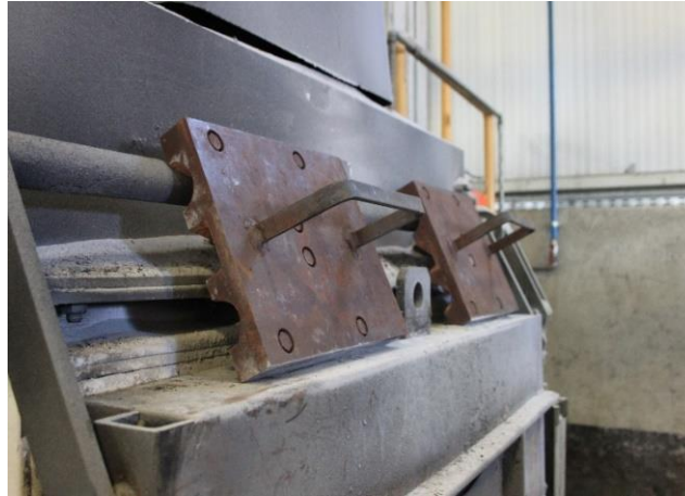
Slika 42. Predgrijavanje ASTM kokile na vratima peći
