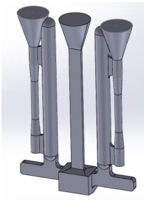
Slika 41. 3D model odljevka lijevanog u ASTM kokilu
