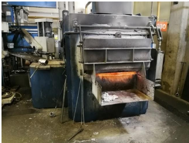
Slika 39. Peć za taljenje legura aluminija u ljevaonici Almos d.o.o.
