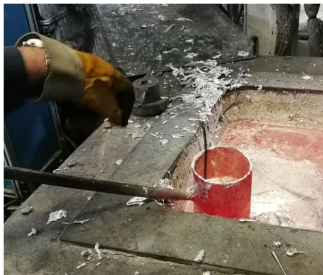
Slika 45. Miješanje taline u lončiću za lijevanje nakon dodatka cjepiva
