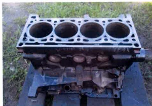
Slika 19. Blok motora očišćen mehaničkim i kemijskim putem
