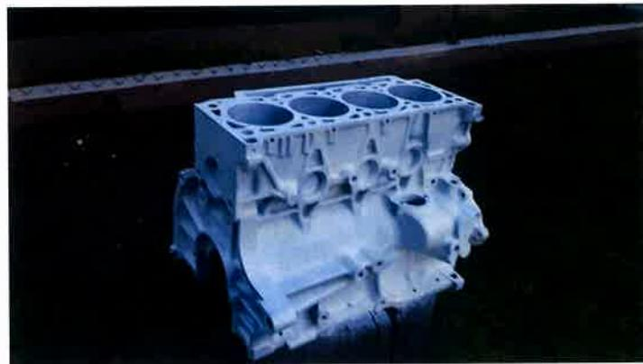
**Slika 20.** Blok motora zaštićen temeljnom bojom
