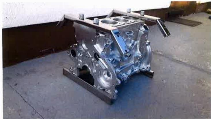
**Slika 21.** Blok motora zaštićen od korozije kromovom prevlakom
