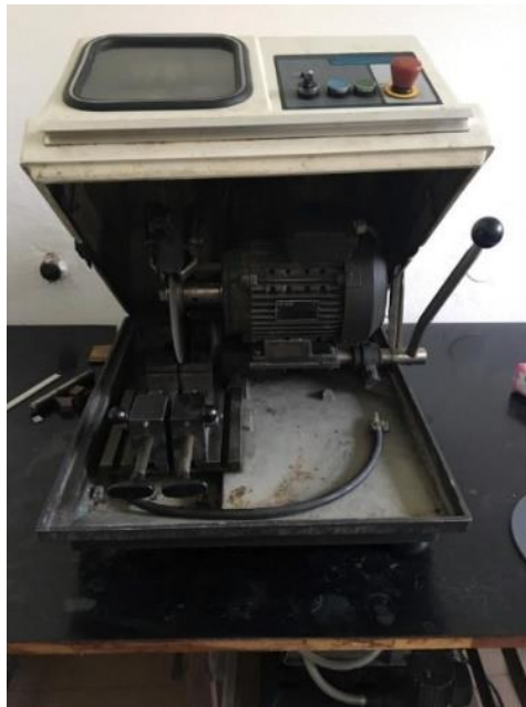
Slika 33. Uređaj Buehler ABRASIMET 2 za rezanje uzoraka kod metalografske pripreme
