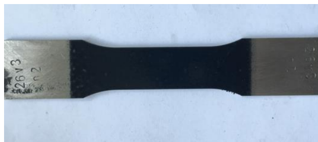
Slika 30. Uzorak nakon nanošenja crnog mat premaza
