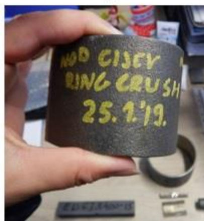
Slika 37. Fotografije uzoraka cijevi: a) sivog lijeva oznake CIJEV 20, b) sivog lijeva oznake CIJEV 23, c) nodularnog lijeva oznake CIJEV NL
